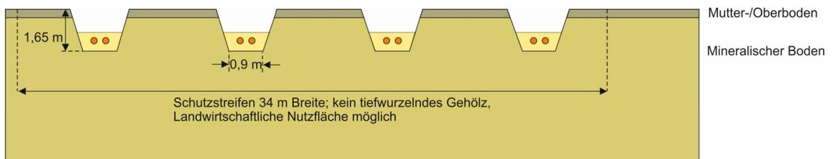
Abb. 1: Schematisches Regelprofil für die offene Bauweise des HGÜ-Erdkabels (nach [39])
